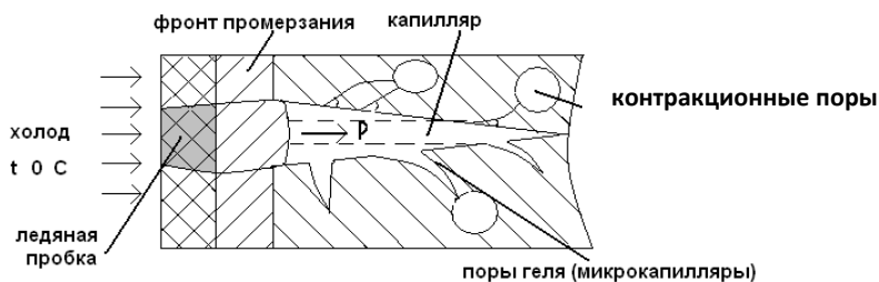
Рис. 1. Процесс промерзания бетона за счёт капиллярных пор
